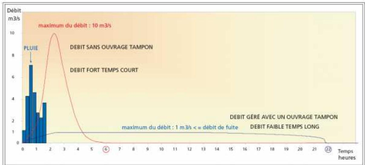
Hydrogramme de principe d'un ouvrage tampon (crédit : n.c.)
